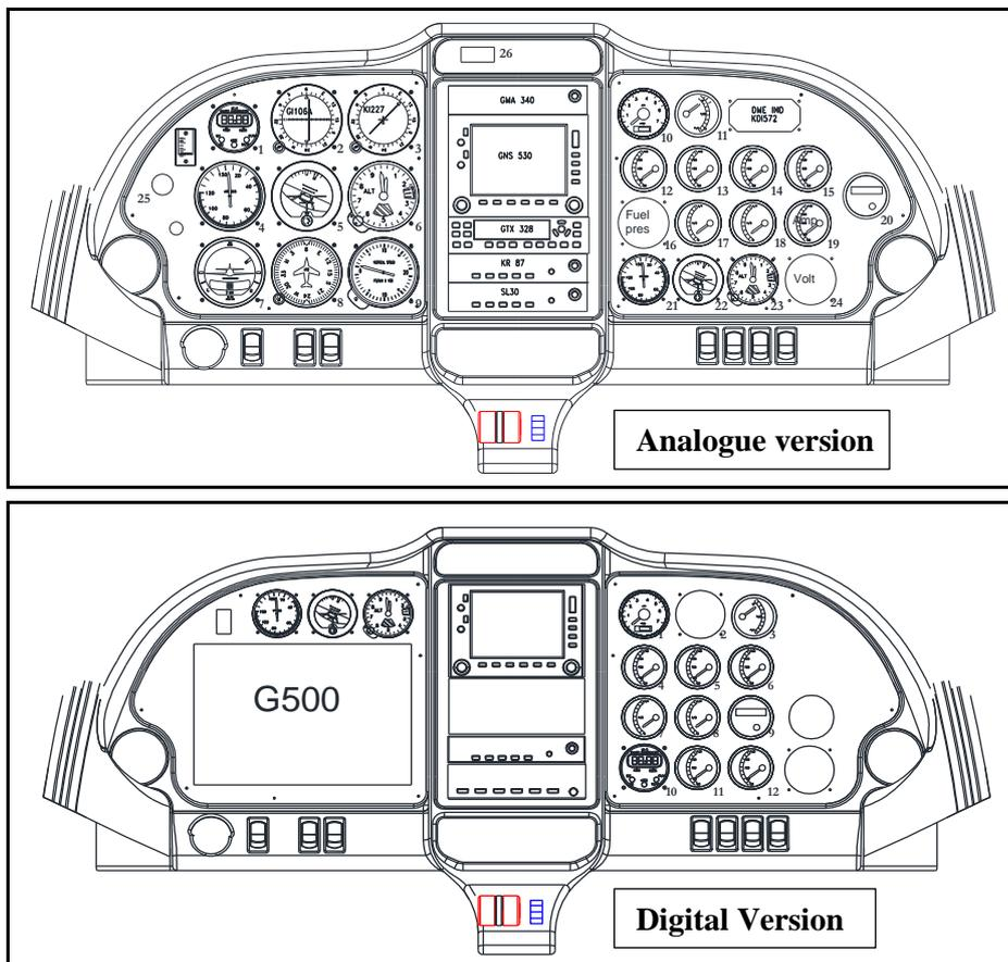
Fig. 7-2. INSTRUMENT PANELS
