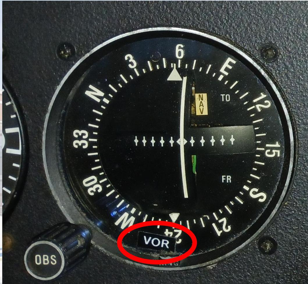
Fonctionnement classique d'un OBI traditionnel, avec l'OBS, l'aiguille et le TO/FROM
