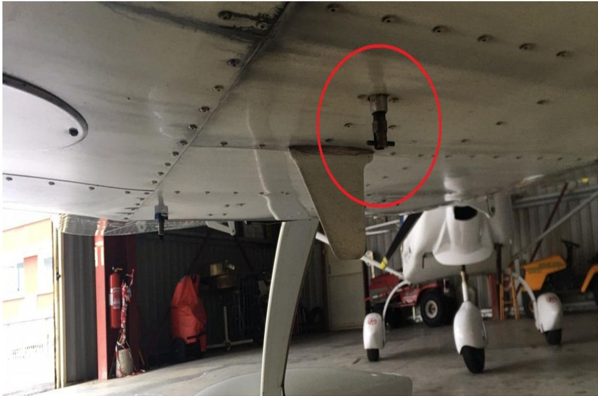
Près de l'antenne transpondeur sur les P2002 « récents » , Position de la purge du circuit statique, qu'il ne faut pas manipuler et vérifier qu'elle soit bien en position fermée, donc non comprimée et verrouillée.
