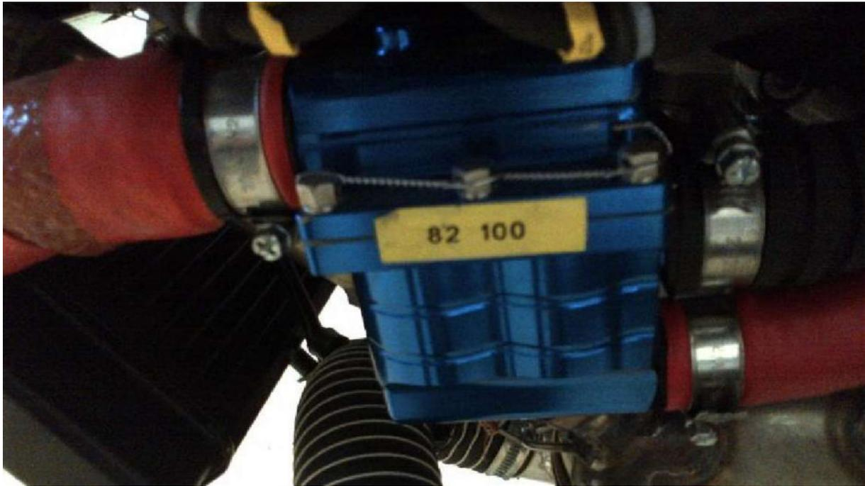
Ce boîtier est un calorstat, c'est un optionnel, selon les avions il peut être absent ou alors il peut être installé sur le circuit d'huile moteur et/ou de liquide de refroidissement (F-AM et F-TG pour les 2 circuits, et F-GM sur le seul circuit Huile). Ils sont là pour optimiser la mise en température et le maintien dans des valeurs de "plage verte" de température.
