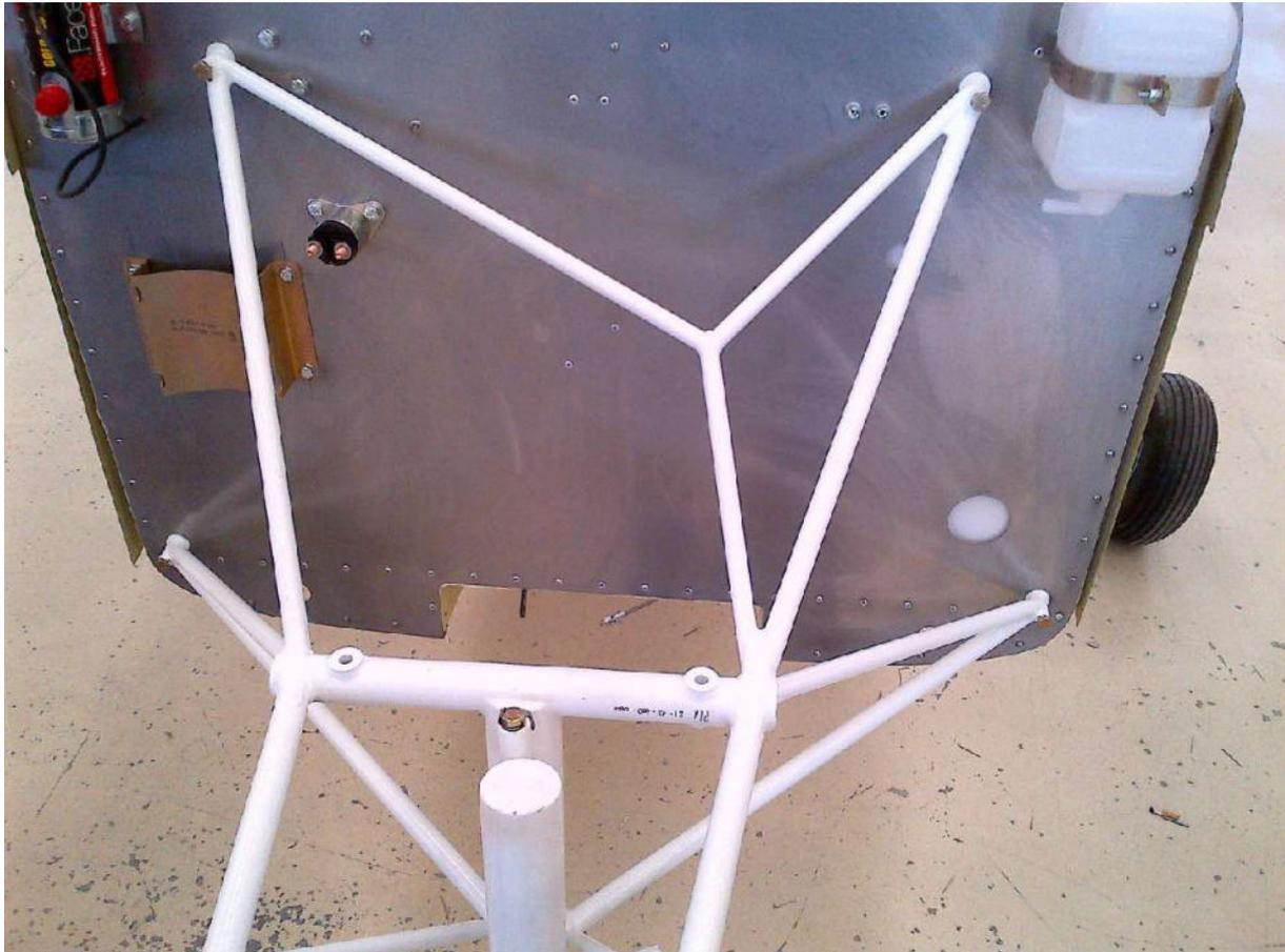
Bien sensibiliser, les élèves et pilotes sur le poser avec le train principal. Le bâti moteur et l'amortissement de la roue auxiliaire par silentblocs ne sont vraiment pas dimensionnés pour atterrir "3 points".
