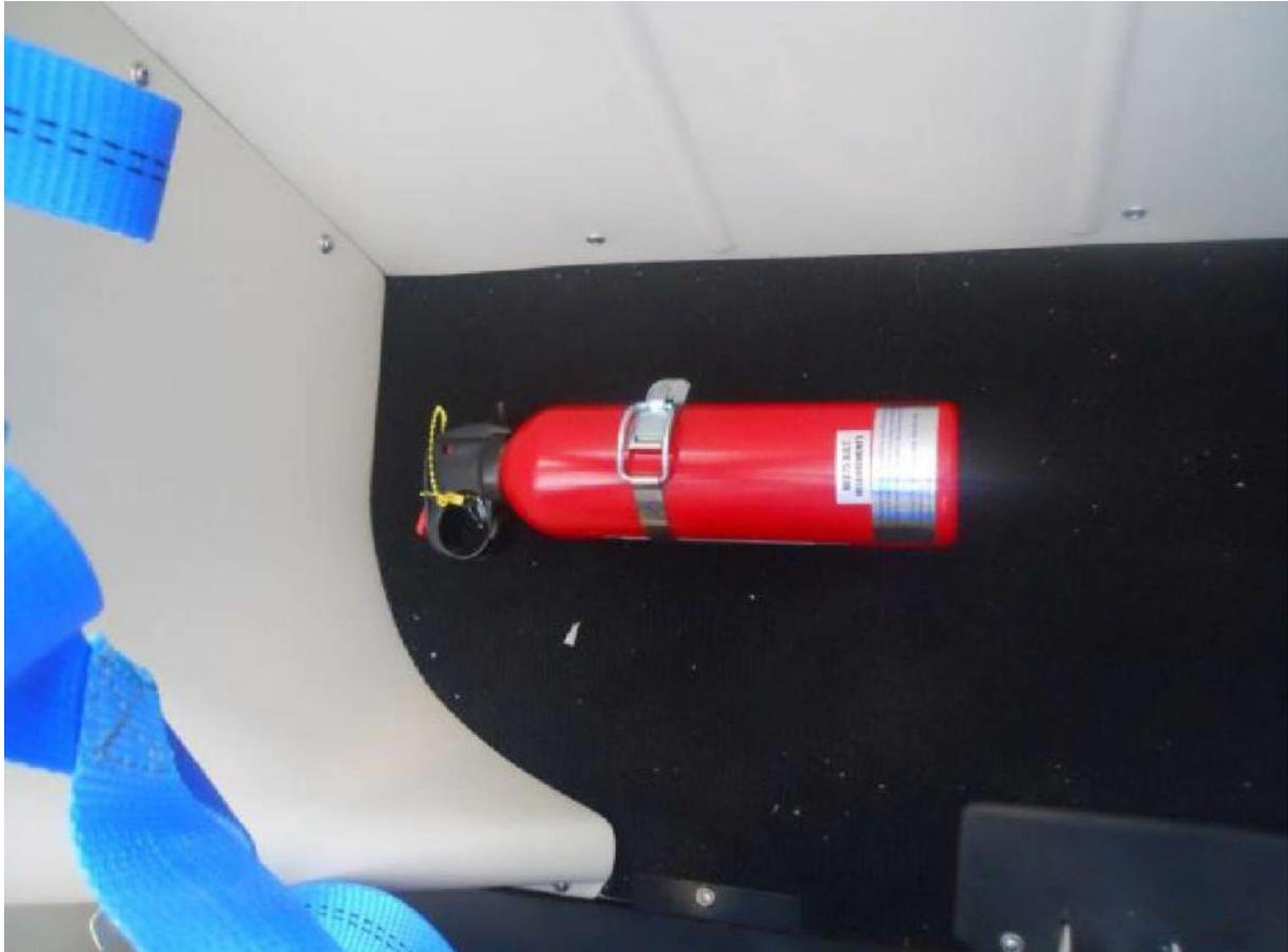
C'est un extincteur à pression permanente, il faut vérifier qu'il est dans la plage verte de pression. Situé derrière le siège droit sous le filet cabine, les pilotes posent dessus toutes sortes de choses et surtout les retirent sans faire attention s'ils accrochent ou non la goupille et le freinage. C'est rare mais arrive que le freinage soit cassé.
