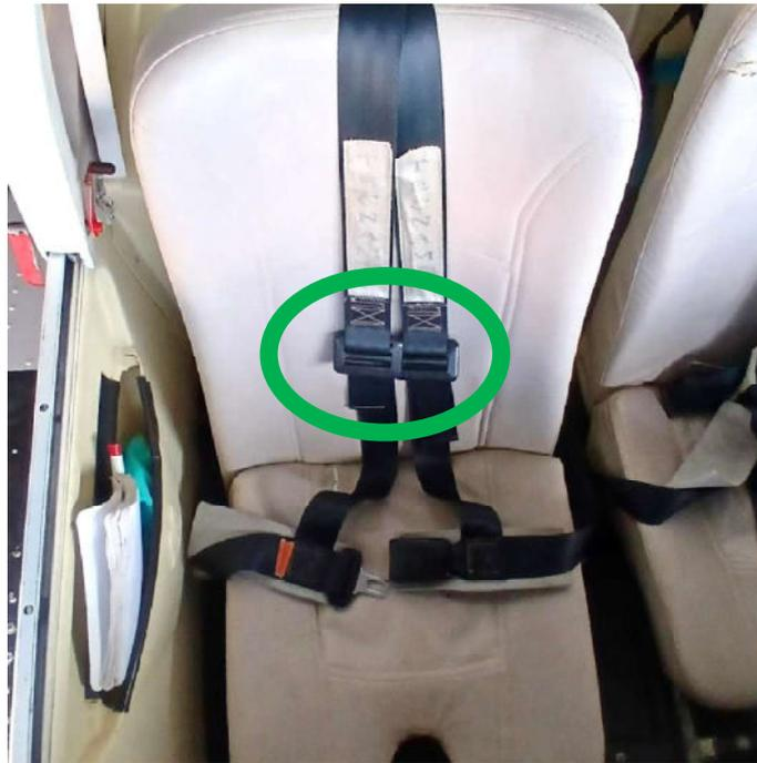
Le réglage des sangles côté parois latérales et arrière est particulièrement difficile à faire lorsqu'on est assis à bord. Ne pas hésiter à sortir pour les régler et confirmer le bon réglage.
