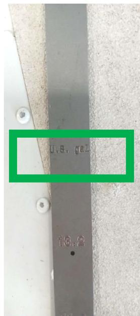
Située dans la cabine sur la paroi côté D, elle est graduée sur les 2 côtés pour la jauge officielle TECNAM. Un côté en litres et l'autre en US gallons (1 US gal = 3,785 litres).
