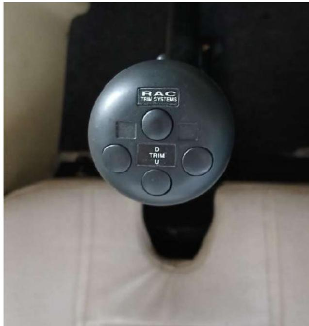
Un TRIM électrique comprenant un indicateur de position et un TRIM SWITCH, pour pouvoir l'utiliser de son côté (PILOTE à gauche ou INSTRUCTEUR à droite), le sélecteur doit être mis sur la bonne position (Left Hand ou Right Hand). L'avion est uniquement compensé sur l'axe de tangage. La position Neutre Décollage est au milieu de l'indicateur, au travers du bouton TRIM SWITCH.
