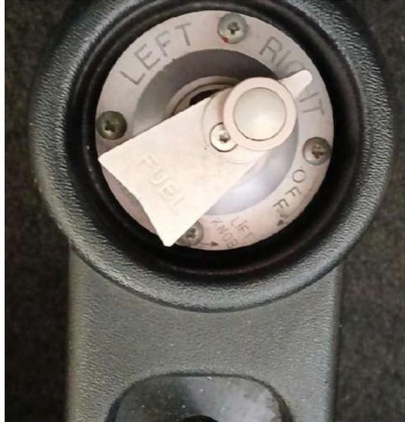
Le sélecteur doit être mis à fond en butée en position LEFT ou RIGHT, entre les 2 positions, non positionné en butée, cela peut fonctionner ou pas. En tout cas, ce n'est pas prévu tel quel. Il y a une bague à soulever pour le basculer en position OFF et verrouiller le circuit carburant.
